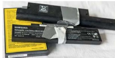
**Bild oben:** Mithilfe eines Klebebandes können ausgebaute Lithium-Ionen-Akkus leicht gesichert werden
